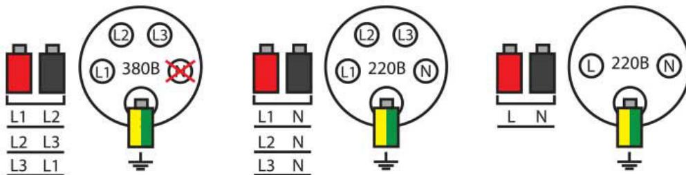
При подключении аппарата к сети 230В следует обратить особое внимание на характеристики розетки и сечение кабеля сети. Стандартная бытовая проводка 230В рассчитана на токи до 16А, поэтому использование аппарата в обычной сети рекомендуется на сварочных токах до 150А с электродом до 3мм.
