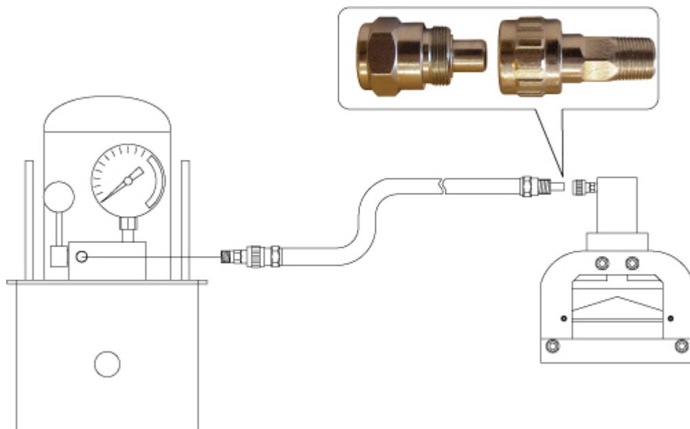
Используя разветвитель гидравлический НРГ-4, позволяет подключать одновременно до четырёх инструментов к станции.
